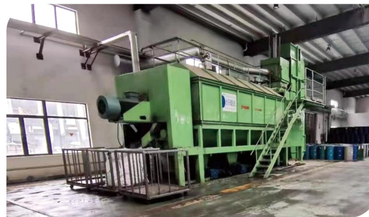
危废金属桶破碎清洗装置
